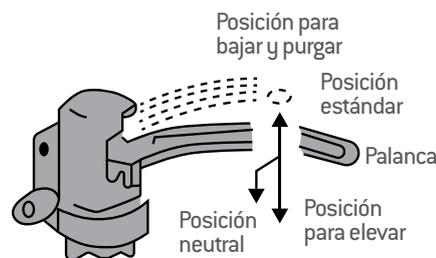
Empuje la palanca hacia arriba cuando el levantamiento esté inactivo o no esté en posición de levante, realice varios movimientos de bombeo hasta su límite y sostenga firmemente la palanca. Cuando esta baje la bomba se purgará a través de la válvula de liberación.
