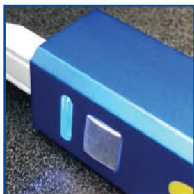
Indicador LED que mide el nivel de potencia actual en el banco de energía.
