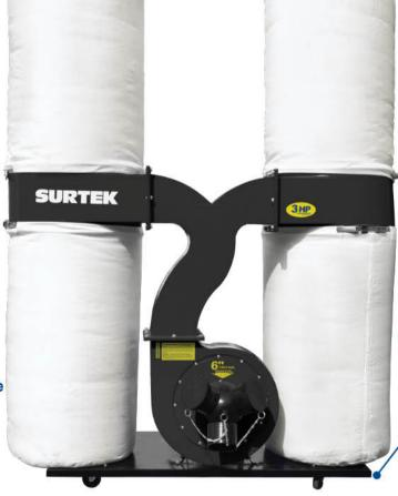
Base con ruedas para facilitar el traslado de la máquina.
