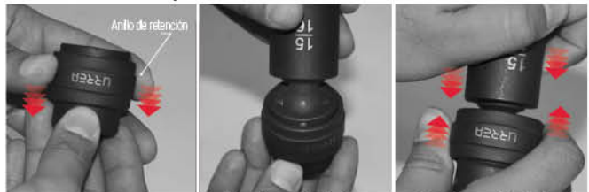
Método de acoplamiento de dados universales intercambiables
