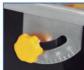
Mesa inclinable de 0 a 45°, para cortes biselados.
