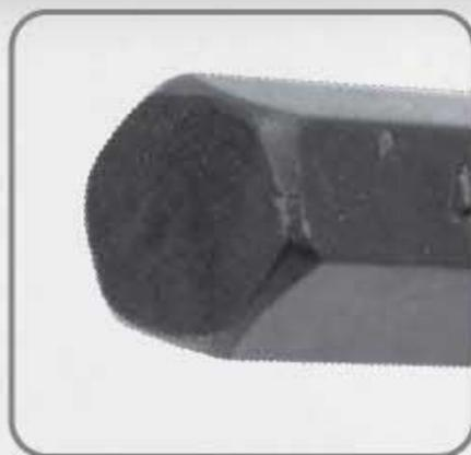
Los puntos a 50° se utilizan para marcar las piezas durante el proceso de fabricación o ensamble.
