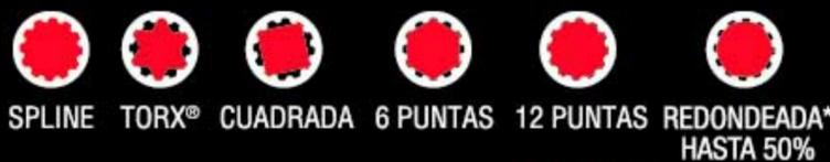
Una sola llave con geometría **SPLINE** puede sustituir hasta 3 llaves distintas.
