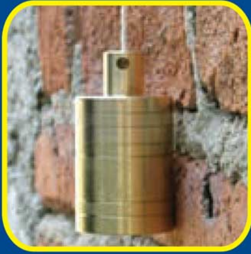
Verificar la verticalidad de muros
