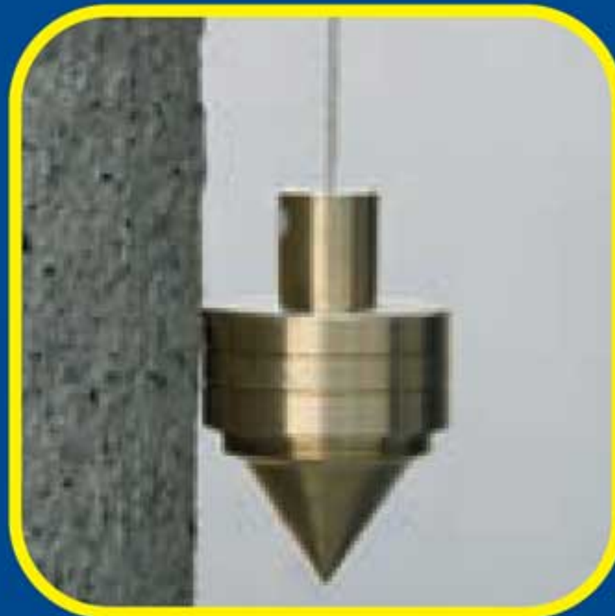
Verticalidad de columnas
