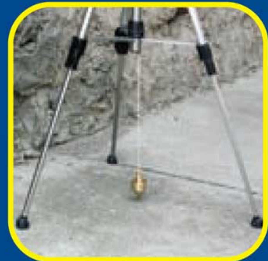
Centrado de perforaciones
