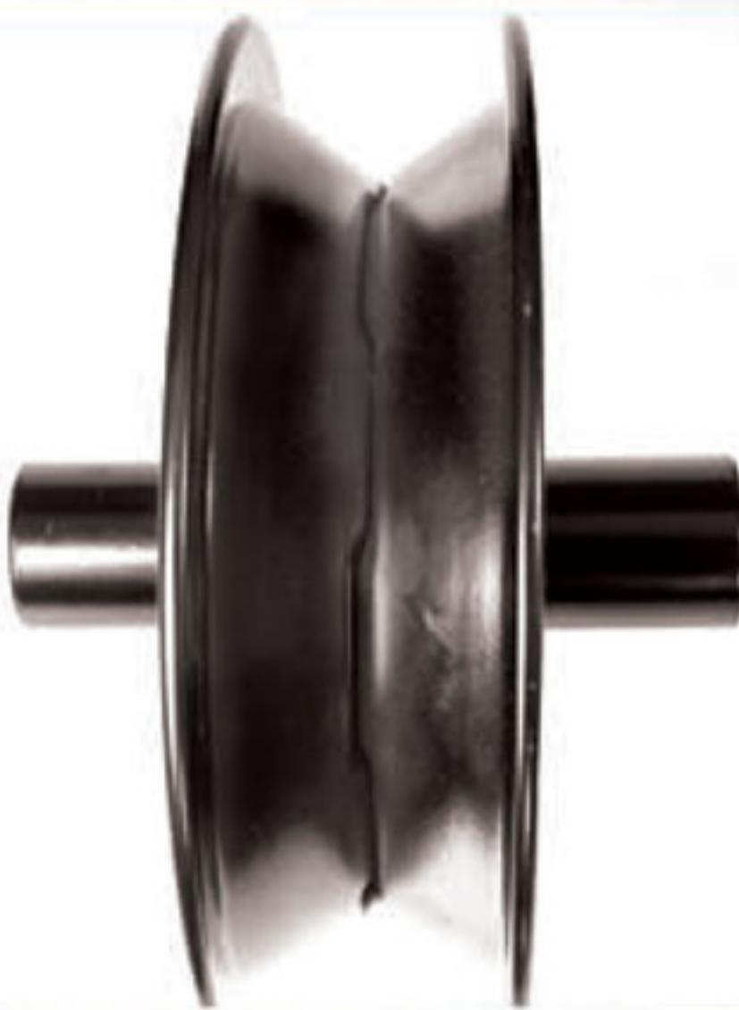
El laboratorio de URREA TEST Center se comprobó de la durabilidad del rin. Se cargó una carretilla de 4.5 pies cúbicos con 200kgs, haciéndola rodar durante más de 150 horas consecutivas sobre un dispositivo que imita el uso rudo, demostrando que el rin y la carretilla soportan uso extremo, a diferencia de las carretillas de la competencia que soportan en promedio 120 horas.
